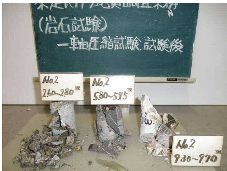
一軸圧縮試験後供試体 No.2孔
