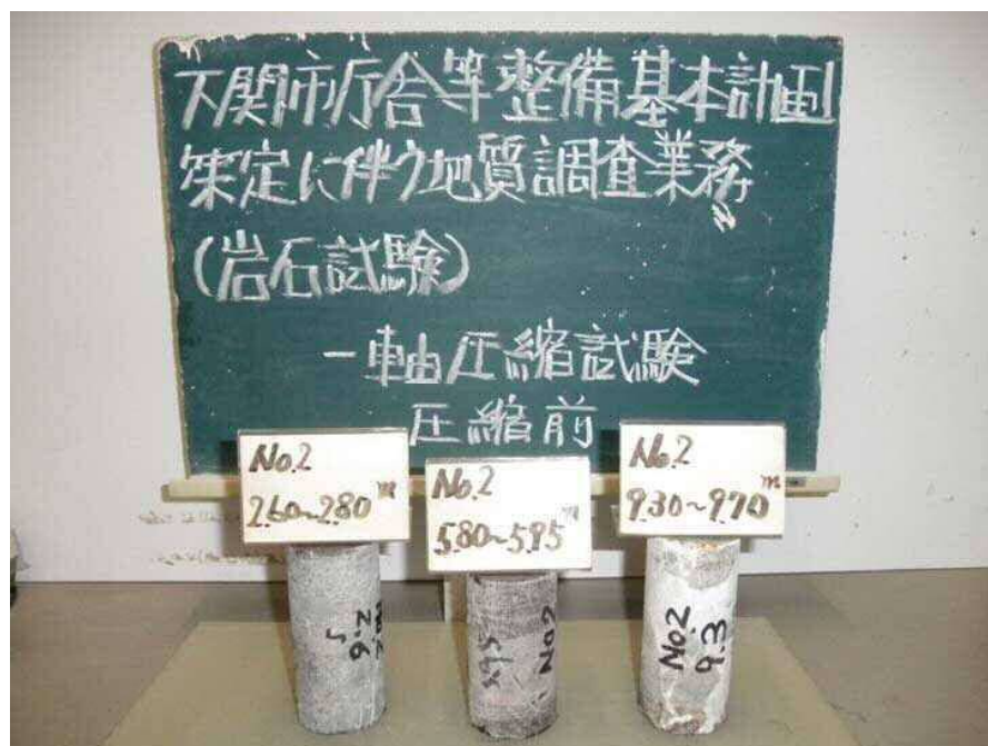
一軸圧縮試験前供試体 No.2孔
