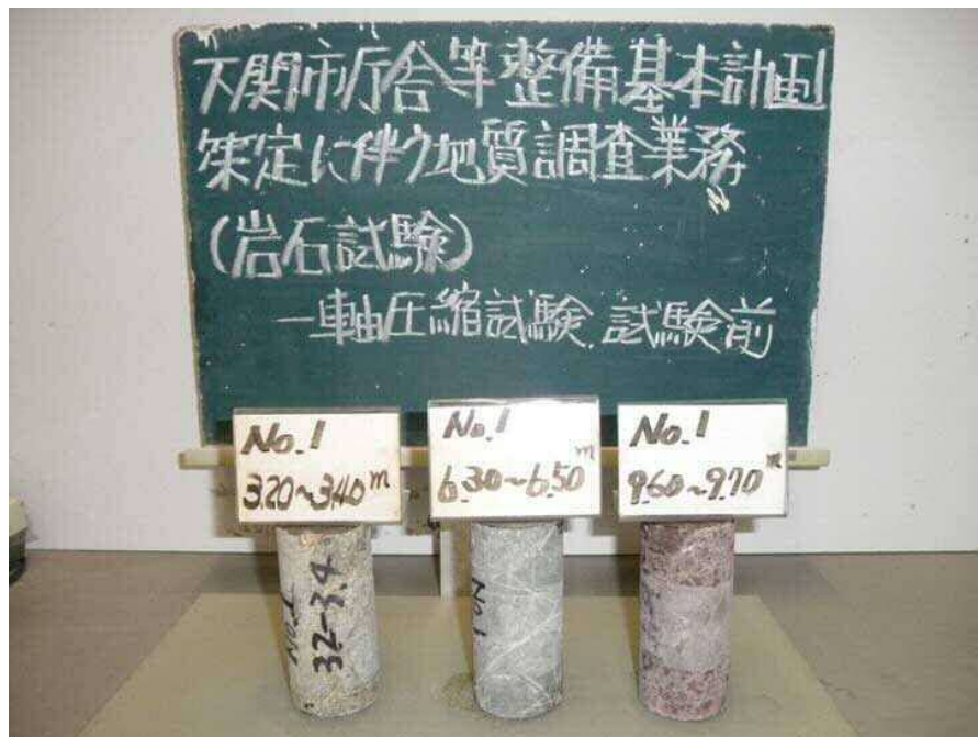
一軸圧縮試験前供試体 No.1孔
