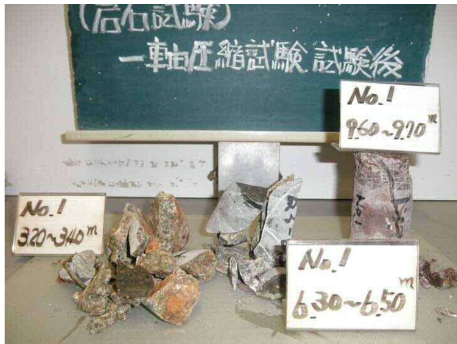
一軸圧縮試験後供試体 No.1孔
